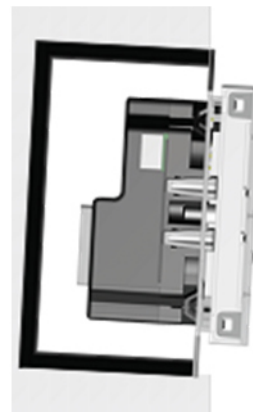
Unterputzdose falsch eingebaut
